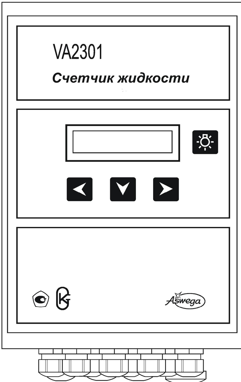
Рисунок 5 - Вид спереди вычислительного блока
