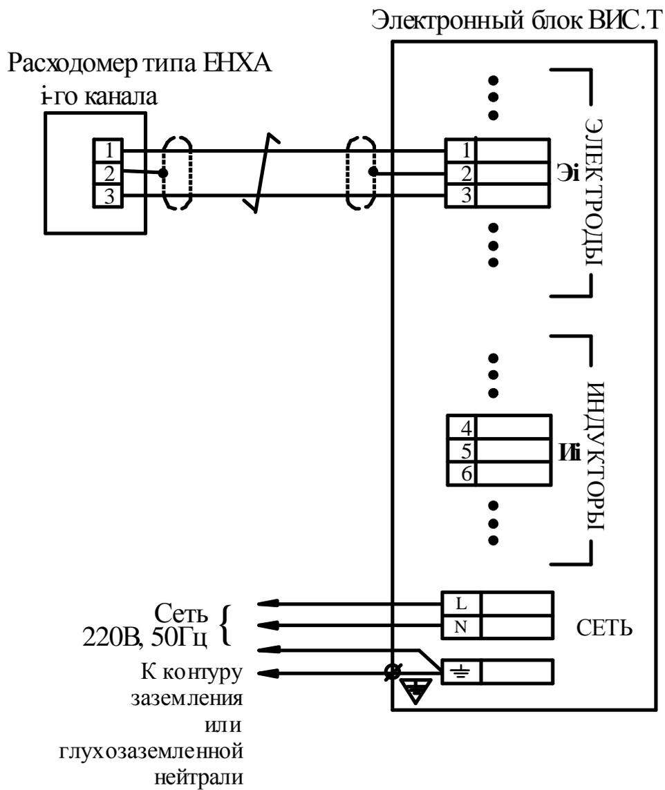
**ПОДКЛЮЧЕНИЕ ВОДОСЧЕТЧИКОВ ТИПА ЕНХА**
