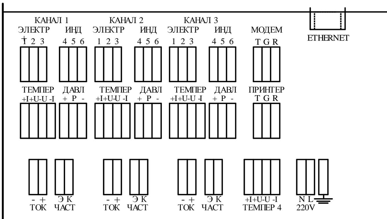
**Рис. 1. Блок электронный на 1 – 3 канала (варианты)**
