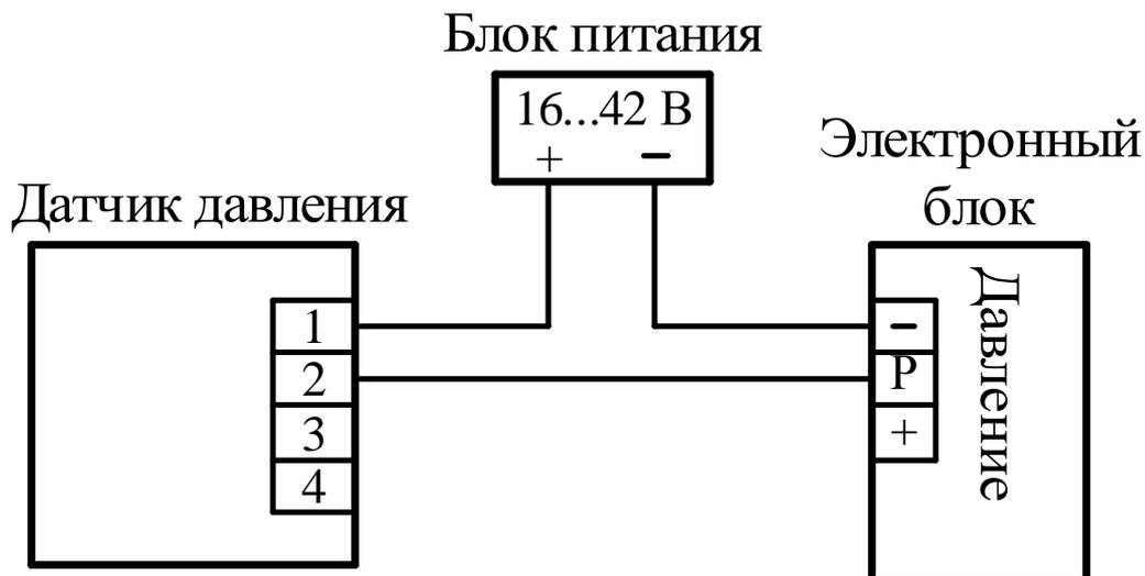
**ПРИМЕР ПОДКЛЮЧЕНИЯ ВНЕШНЕГО БЛОКА ПИТАНИЯ ДЛЯ ДАТЧИКОВ ДАВЛЕНИЯ КРТ5, КРТ9**
