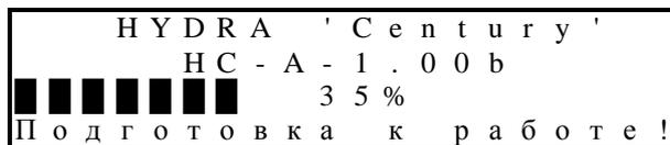
В случае продолжительного нахождения ВИС.Т в выключенном состоянии, подготовка к работе может занять некоторое время. В этом случае в третьей строке жидкокристаллического дисплея присутствует индикатор хода подготовки к работе (см. рисунок выше). После выхода из режима подготовки к работе ВИС.Т производит инициализацию подключенного модема (если модем указан как подключенное устройство, см. п. 2.3.5.4.4) и возвращается в тот режим индикации, в котором он находился в момент отключения питания.
